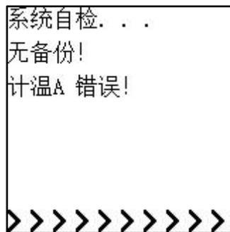
图 2 开机显示界面（有故障时）
